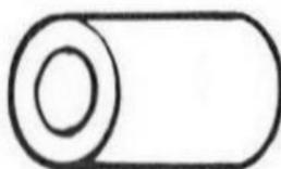
Montera de 6 distanshylsorna från kretskortets kopparsida med 6 skruvar M3 x 12 mm och 6 muttrar M3. Löda kring distanshylsorna, så att de sitter fast. Skruvar och muttrar kan nu avlägsnas för senare montering i SYSTEM 350-lådan.
