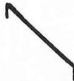
De 7 överbryggningarna monteras på kretskortet vid streckmarkeringarna. Använd ledningsavklipp från monteringen av elektrolytkondensatorerna. Böj till, klipp och löda.
